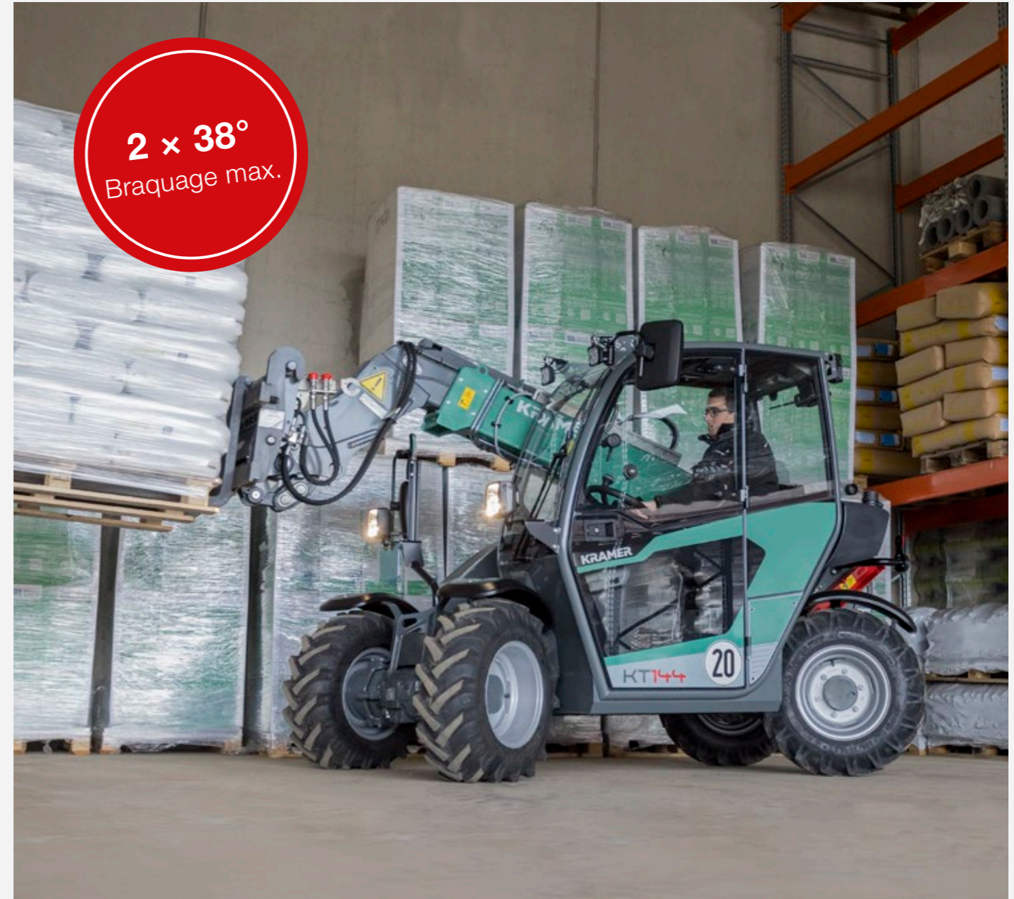
Quatre roues directrices : particulièrement maniable dans les espaces restreints
